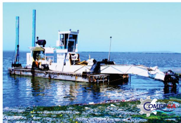
Draga anfibia autopropulsa de corte frontal con envío hidráulico.
