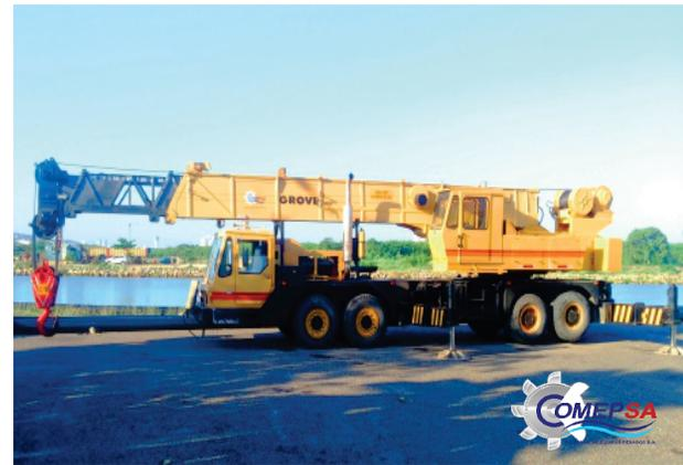
Grúa hidráulica telescópica, con aguilón trapezoidal envío hidráulico
