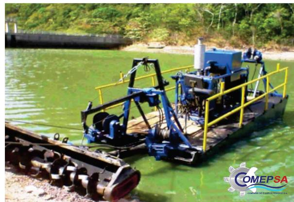
Draga modular de corte frontal con envío hidráulico.
