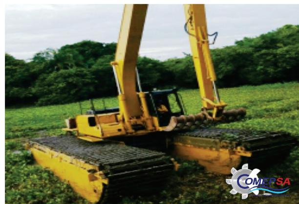
Excavadora anfibia autopropulsada con pontones de esterillas y brazo largo
